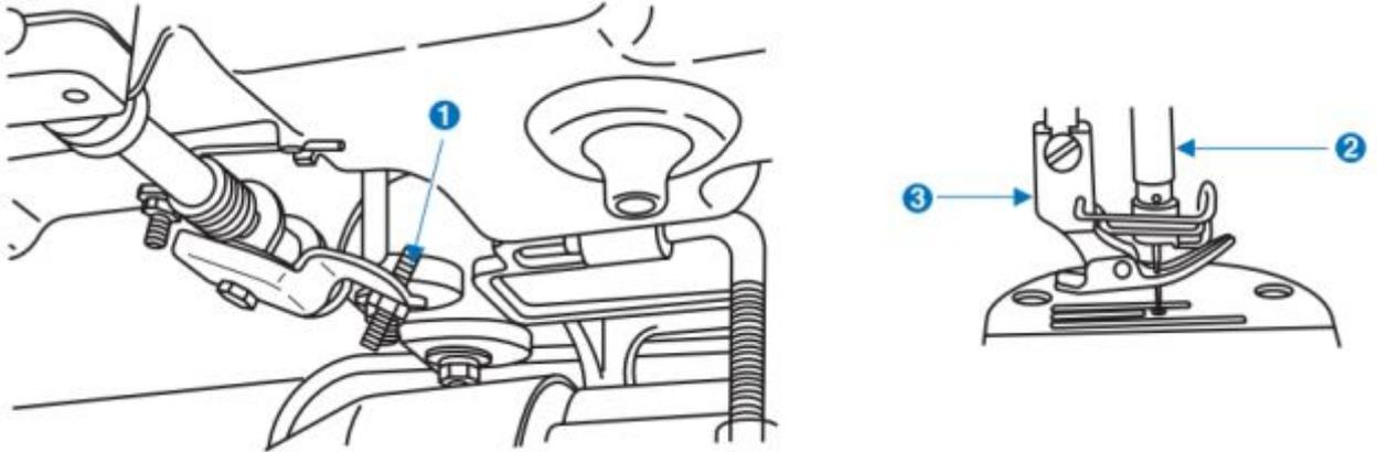
1. Стандартная величина подъема прижимной лапки с помощью коленоподъемника составляет 10 мм.
